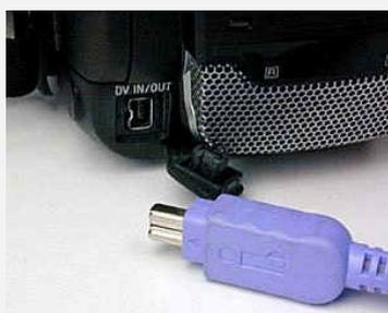
Una porta **firewire** permette di collegare al computer, o di collegare fra loro, in modo **particolarmente veloce**, vari dispositivi come **fotocamere digitali**, webcam, hard disk esterni, ecc.
