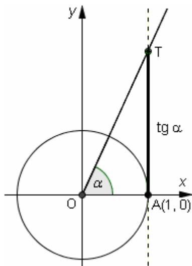
**$\text{tg } \alpha = \text{ordinata di T} = \text{misura (con segno) di AT}$**
