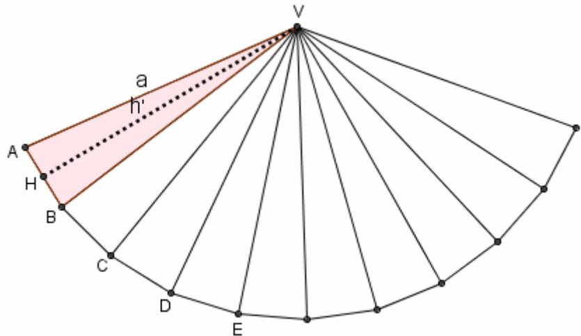
dove  $h' = VH$  non è esattamente l'apotema del cono, ma differisce ben poco da esso, e anzi sarebbe ancora più prossimo all'apotema  $a = VA$  del cono se i lati del poligono, anziché 10, fossero 1000 o 1000000.
