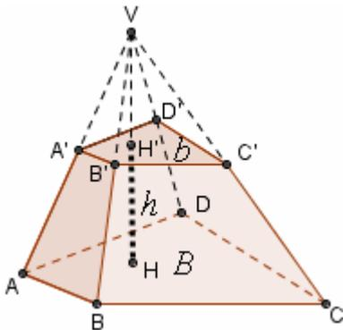
Se non si ricorda la formula si può ricavare il volume come differenza fra i volumi di due piramidi; per calcolare le altezze di queste si potrà tener conto del teorema nel riquadro in fondo al paragrafo 2.
